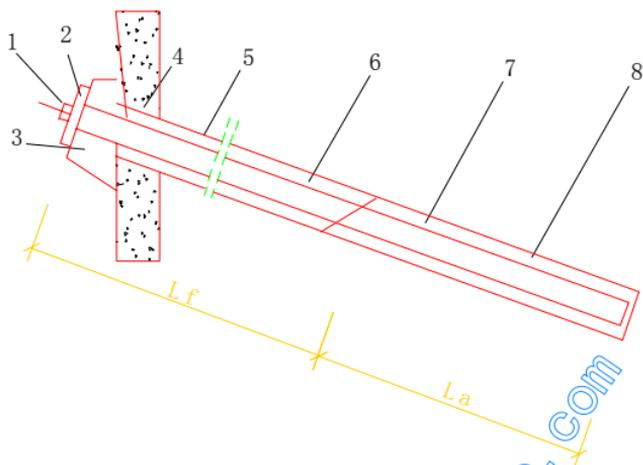
图 2.2.2—1 圆柱型锚固体锚杆
