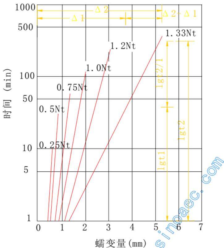
附图8.4 蠕变试验的蠕变量—时间对数曲线
